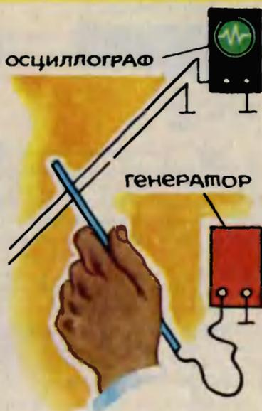
группа идей — подключать к поврежденному проводу электрическое или магнитное поле и с помощью датчика-приемника измерять его величину до и после места обрыва. Этот способ специалисты отрасли бытового обслуживания непременно используют в своих дальнейших разработках. Он позволяет обнаружить место обрыва даже в скрытой в стене проводке.
